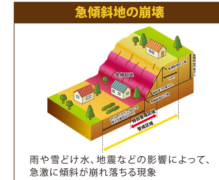
雨や雪だけ水、地震などの影響によって、急激に傾斜が崩れ落ちる現象
